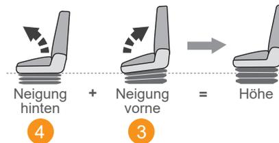
Hebel (3) hochziehen und Sitzneigung durch Be- und Entlasten im vorderen Bereich des Sitzkissens verändern.
